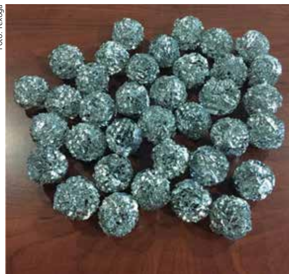
Deto-Stop: Kugeln aus einem Aluminium-Gitternetzwerk, durch die eine Entzündung eines Kraftstoff-Luftgemisches in Tanks verhindert werden soll
