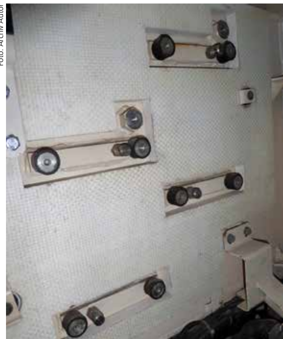
Auskleidung der Turmseitenwand in einem KPz Leopard 2 A5 mit einem Anti-Spall-Liner
