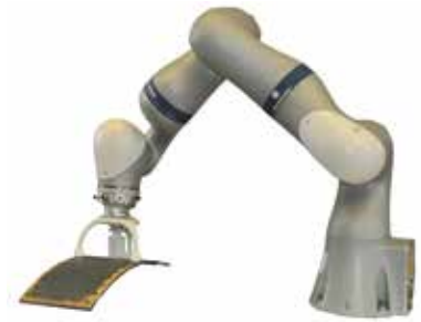
Reales Hubschrauberheck (l.) und mittels 3D-Scan erzeugtes CAD-Modell (m.), Leichtbauroboter, der eine Ultraschallprüfung auf CFK durchführt (r.)
