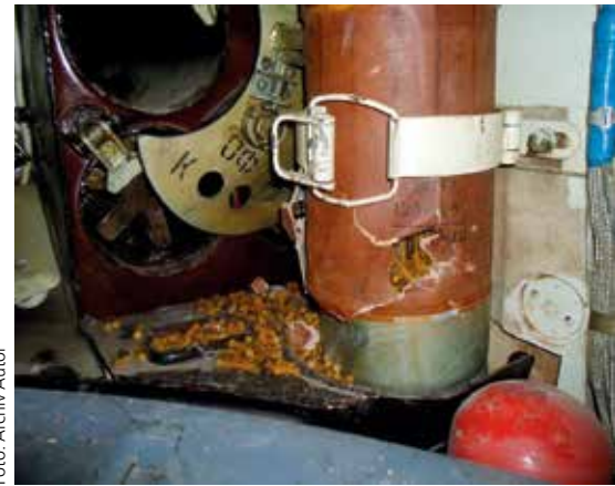
Offen liegende Treibladung hinter dem rechten Bugtank bei einem KPz T-72 (hier mit beschädigter Treibladungshülse und ausgetretenem Treibladungspulver); unter diesen Randbedingungen werden Bilder verständlich, auf denen sich der Turm nach Beschuss und Deflagration der Treibladung vom Fahrgestell gelöst hat
