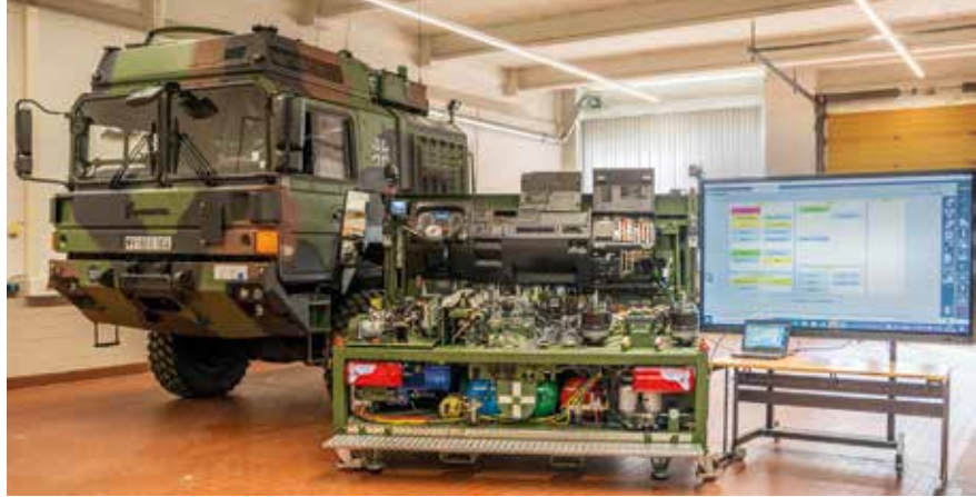
Ausbildungsstation UTF mit Ausbildungssimulator Frame Electric System
