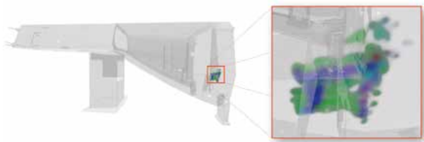
Sicht des Prüfers in einer virtuellen Umgebung; C-Bild einer Ultraschallprüfung integriert in ein semitransparentes CAD-Modell
