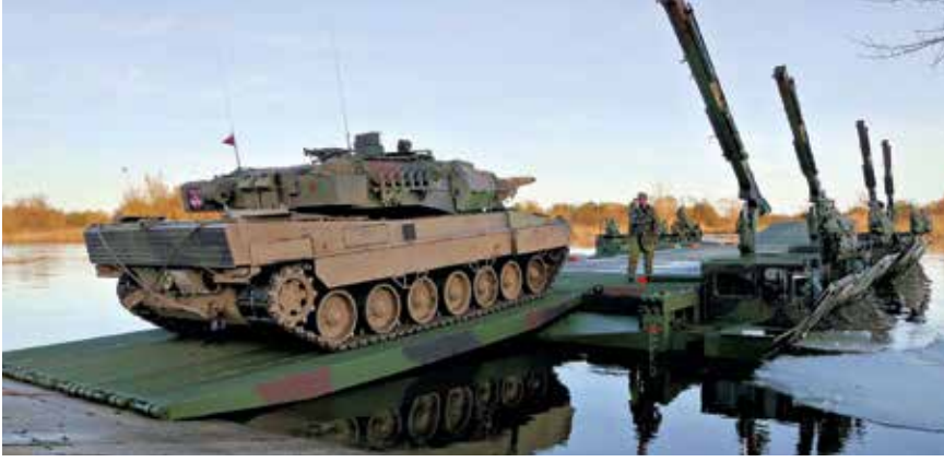
Brücke gebildet aus Amphibien M3, die in Zukunft durch die Schnellschwimmbücke 2 ersetzt werden sollen
