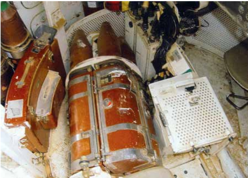
Munitionsschutz in einem KPz Merkava: Das verwendete Material für die Unterbringung der Patronen zeigt eine endotherme Wirkung bei der Phasenumwandlung fest-flüssig; damit bleibt auch bei äußerer Hitzebelastung der Innenraum des Behälters über lange Zeit kühl
