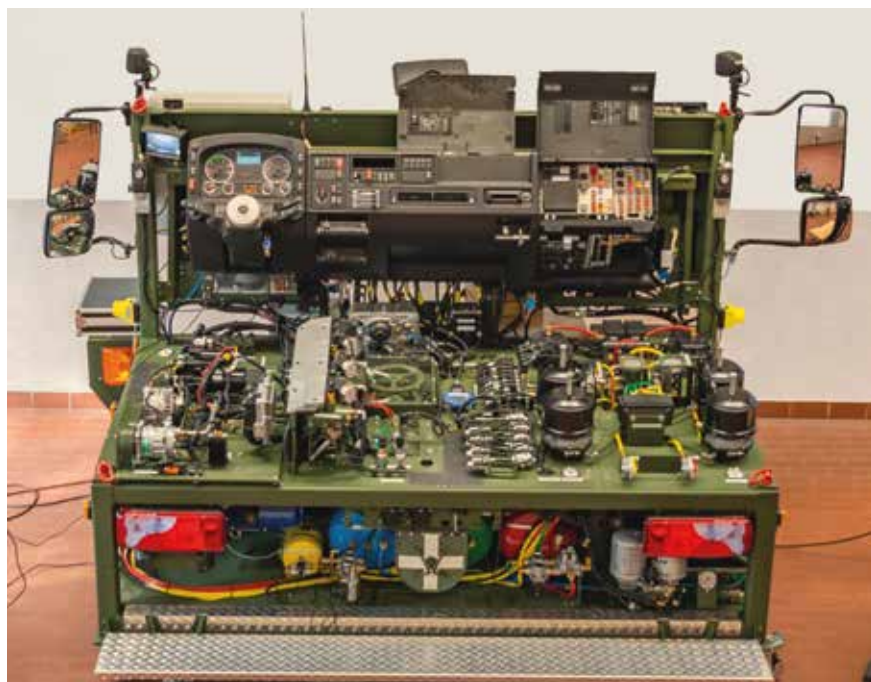
Frame Electric System – Ausbildungssimulator für die Technik des Ungeschützten Transportfahrzeugs
