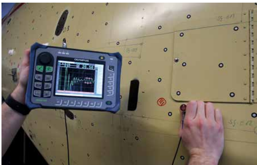
Klassische Ultraschallprüfung an einer CFK-Hubschrauberstruktur
